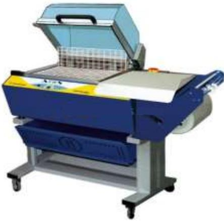
Machine sur socle mobile pour emballer différents produit avec un film pli simple thermosoudable, dans les limites dimensionnelles, et avec soudure angulaire 32 x 43 cm ( dite soudure en L)
